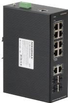
Коммутатор NIKOMAX, L2, индустриальный на DIN рейку, 8 PoE 10/100/1000Мбит/с (af/at), 2 PoE 10/100/1000Мбит/с (BT), 2 SFP 1000Мбит/с, 2 SFP 2.5Гбит/с, 1 Console, питание 48В (блок питания поставляется отдельно 420 Ватт)
