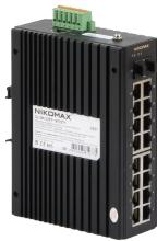
Управляемый промышленный L2 коммутатор NIKOMAX, 16\*10/100/1000Мбит/с PoE (af/at), 2\*1/2.5/10Гбит/с SFP+, Крепление на DIN-рейку, 2\*ввода питания, питание 44-57В (блок питания 240Вт поставляется отдельно), -40С +75С.
