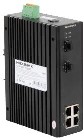
Промышленный PoE коммутатор , L2+ NIKOMAX, 4\*10/100/1000Мбит/с PoE (af/at/BT) из которых 2 порта PoE BT, 2\*1/2.5Гбит/с SFP, крепление на DIN-рейку, 2\*ввода питания, питание 44-57В (блок питания 240Вт поставляется отдельно), -40С +75С
