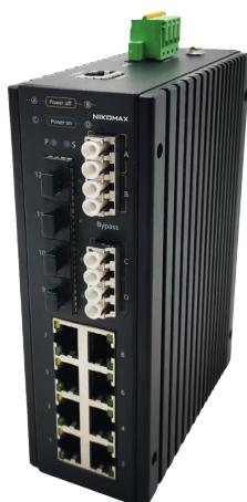
Управляемый промышленный L2+ коммутатор NIKOMAX, 8\*10/100/1000Мбит/с PoE (af/at/BT) из которых 2 порта PoE BT, 4\*1/2.5Гбит/с, 2 Канала Bypass (8\*LC), Крепление на DIN-рейку, 2\*ввода питания, питание 44-57В (блок питания 240Вт поставляется отдельно), -40С +75С
