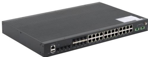
Управляемый промышленный L2+ коммутатор NIKOMAX, 16\*10/100/1000Base-T PoE (af/at, 2 порта с поддержкой BT), 8\*1G Combo SFP/RJ45, 4\*1/2.5/10G SFP+, Крепление в стойку 19", 2\*ввода питания, питание DC 44-57В (блок питания поставляется отдельно), USB, -40С +75С
