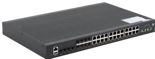
Управляемый промышленный L2+ коммутатор NIKOMAX, 16\*10/100/1000Base-T PoE (af/at, 2 порта с поддержкой BT), 8\*1G Combo SFP/RJ45, 4\*1/2.5/10G SFP+, Крепление в стойку 19", 2\*ввода питания, питание DC 44-57В (блок питания поставляется отдельно), USB, -40C +75C
