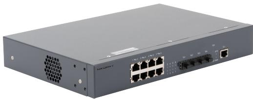
Управляемый коммутатор NIKOMAX, L3 Stack, 8\*1/2.5 Гбит/с BASE-T, 4\*1/10 Гбит/с SFP+, 1\* Консольный порт RJ45
