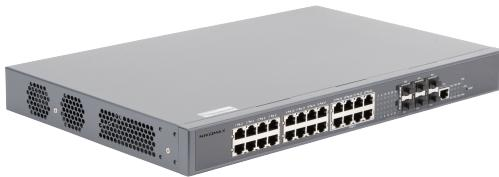
Управляемый PoE коммутатор NIKOMAX, L3 Stack, 8\*1/2.5 Гбит/с BASE-T 802.3BT, 16\*1/2.5 Гбит/с BASE-T 802.3at, 6\*1/10 Гбит/с SFP+, 1\*Консольный порт RJ45
