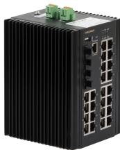
Управляемый промышленный L3 коммутатор NIKOMAX, 24\*10/100/1000Мбит/с PoE (af/at/BT) из которых 4 порта PoE BT, 4\*1/2.5/10Гбит/с SFP+, Крепление на DIN-рейку, 2\*ввода питания, питание 44-57В (блок питания 370Вт поставляется отдельно), -40С +70С.
