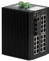
Управляемый промышленный L3 коммутатор NIKOMAX, 24\*10/100/1000Мбит/с PoE (af/at), 4\*1/2.5/10Гбит/с SFP+, Крепление на DIN-рейку, 2\*ввода питания, питание 44-57В (блок питания 370Вт поставляется отдельно), -40С +70С.
