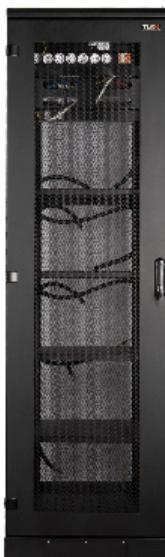
Комплекс бесперебойного питания 6кВА на базе шкафа TFA - GL-UPS-OL06-1-1-pf.1.0/xxU81. Является готовым решением для питания различного оборудования, представляет собой ИБП GL-UPS-OL06-1-1-pf.1.0 установленный в шкаф на 42/47 У оборудованный полками для размещения АКБ, оборудованные с двух сторон блоком розеток и оснащенный картой SNMP для удаленного мониторинга и управления через сеть.
