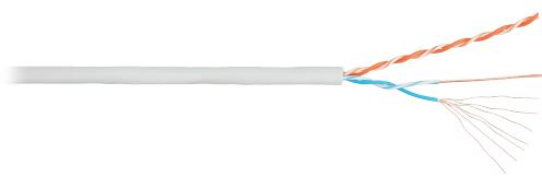
Многожильные кабели предназначены для изготовления коммутационных шнуров (патч-кордов). Каждый проводник состоит из тонких медных жил, свитых между собой, что обеспечивает лучшую физическую устойчивость к многократным изгибам.
