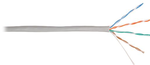
Кабель U/UTP 4 пары, кат.5е, одножильный, медь, 24 AWG, внутренний, PVC нг(A), 305м
