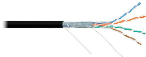
Кабель NIKOLAN 4-парный, экранированный, LSZH, 305 м, выполнен в экранированном исполнении F/UTP, соответствует категории 5е и предназначен как для внутренней, так и для внешней прокладки. Внешняя оболочка изготавливается из не поддерживающего горение LSZH-компаунда, устойчивого к воздействию ультрафиолетового излучения, малодымного и не выделяющего ядовитых соединений в процессе горения, исполнение нг(A)-HFLTx.
