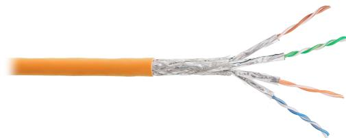
Кабель NIKOLAN 4-парный, экранированный, выполнен в экранированном исполнении S/FTP, соответствует категории 6 и предназначен для внутренней прокладки. Внешняя оболочка изготавливается из неподдерживающего горение LSZH-компаунда, малодымного и не выделяющего ядовитых соединений в процессе горения, исполнение нг(A)-HFLTx. Прокладывается в кабельных каналах, лотках, коробах, трубах, в том числе в вертикальных кабельных каналах. Кабель NIKOMAX соответствует требованиям ГОСТ Р 50331-2009.
