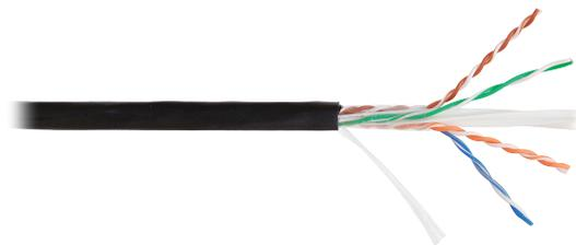
Кабель NIKOLAN 4-парный, категория 6, выполнен в неэкранированном исполнении U/UTP, соответствует категории 6 и предназначен для внешней прокладки. Внешняя жесткая полиэтиленовая оболочка не боится ультрафиолета, устойчива к холоду и внешним воздействиям.
