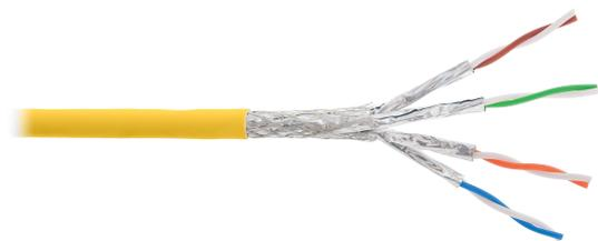
Кабель 8 категории — последнее пополнение в модельном ряду 9-й серии. Индивидуальное экранирование каждой пары (S/FTP, F/FTP) дополнительно защищает от перекрестных наводок внутри кабеля, что гарантирует стабильную работу новейших высокоскоростных приложений на частотах до 2000 МГц.
