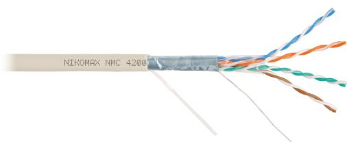
Кабель NIKOMAX, F/UTP, 4 пары, кат.5е, 24 AWG, внутренний, нг(А)-LSLTx, 305м, светло - серый
