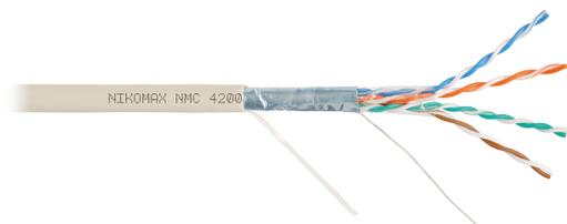
Кабель NIKOMAX, F/UTP, 4 пары, кат.5е, 24 AWG, внутренний, нг(А)-LSLTx, 305м, светло - серый
