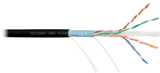
Кабель NIKOMAX, F/UTP, 4 пары, кат.6, 23 AWG, внутренний/внешний, нг(А)-HF, 305м
