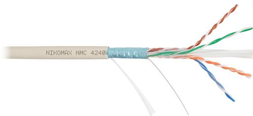
Кабель NIKOMAX, F/UTP, 4 пары, кат.6, 23 AWG, внутренний, нг(А)-LSLTx,
