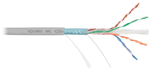
Кабель NIKOMAX F/UTP, 4 пары, Кат.6а, 23 AWG, внутренний, поливинилхлорид, 500м
