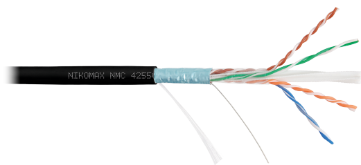
Кабель NIKOMAX F/UTP, 4 пары, кат.6а, 23 AWG, внутренний/внешний, нг(А)-HF, 500м
