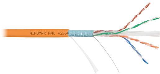
Кабель NIKOMAX F/UTP, 4 пары, кат.6а, 23 AWG, внутренний, нг(А)-HF, где xx-цвет, 500м
