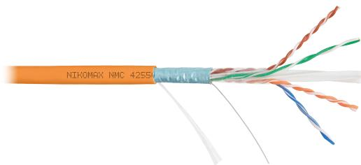
Кабель NIKOMAX F/UTP, 4 пары, кат.6а, 23 AWG, внутренний, нг(А)-HF, где
