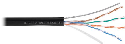
Кабель NIKOMAX U/UTP, 4 пары, кат.5е, 24 AWG, внешний с тросом, полиэтилен, черный, 500м
