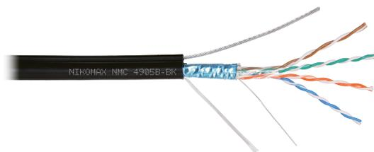
Кабель NIKOMAX F/UTP, 4 пары, кат.5е, 24 AWG, внешний с тросом, полиэтилен, черный, 500м
