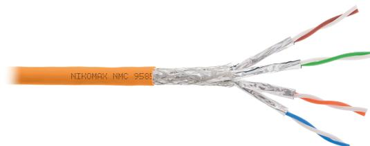
Кабель NIKOMAX S/FTP, 4 пары, Кат.8, 22 AWG, внутренний, полимерный материал, 500м
