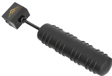
Монтажный инструмент NMC-315DR предназначен для одновременной заделки нескольких пар проводов в кроссы 110 типа. Инструмент представляет собой механическое устройство, предназначенное для механической фиксации жил проводов в контактах кроссового блока или коннектора.
