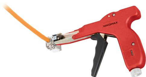
Инструмент NMC-328 предназначен для затягивания и обрезки нейлоновых стяжек шириной до 4,8 мм при толщине до 1,6 мм.
