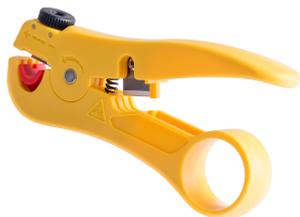
Инструмент NMC-350 предназначен для снятия изоляции и обрезки с витой пары. Наличие колесика для тонкой подстройки глубины хода ножа позволяет сделать точный надрез, не повредив изоляцию проводников под внешней оболочкой.
