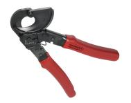
Инструмент NMC-535 снабжен храповым механизмом и предназначен для обрезки медных кабелей диаметром до 32 мм, в том числе многопарных, вплоть до 200-т пар. Также инструмент подходит для силовых кабелей с медной жилой диаметром до 3,5 мм, либо с алюминиевой жилой диаметром до 5 мм.
