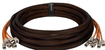
Медная кабельная сборка, кат.6, STP, 6 портов, модули KJ - модули KJ, нг(A)-HF
