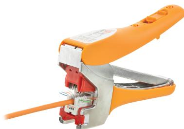
Новая система NIKOMAX «Fast Termination» – это свежий взгляд на монтаж модульных решений. В основе решения лежит специальный инструмент NMC-FT-TOOL, который позволяет моментально обжимать коммутационные модули, облегчая работу и многократно экономя время. Разведите кабель на контактах модуля, вставьте его в инструмент и просто сожмите рукоятки! Аккуратная и качественная заделка модуля в одно нажатие!
