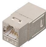
НИКОМАКС NMC-KJSA55C-MT предназначены для наращивания кабельных линий, оконцованных коннекторами RJ45/8P8C, в качестве временного решения, при ремонте поврежденной кабельной линии, а также могут найти применение при построении кабельных линий по системе Cross-Connection.
