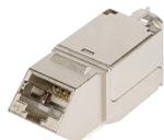
Коммутационные модули NIKOMAX с угловыми портами (серия «AN») относятся к системе Fast Termination и спроектированы специально для использования с инструментом для быстрой заделки NMC-FT-TOOL. Разведите кабель на контактах модуля, вставьте его в инструмент и просто сожмите рукоятки. Аккуратная и качественная заделка в одно нажатие! IDC контакты модулей AN также совместимы с обычным ударным инструментом с ножом 110 типа или KRONE.
