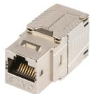
Самозажимные коммутационные модули NIKOMAX спроектированы так, что для их заделки не требуется специального монтажного инструмента. Внутренняя вставка обеспечивает равномерное поступательное движение с перпендикулярным врезанием ножей контактов в жилы кабеля, что гарантирует высокое качество монтажа, не уступающее «классическим» модулям с заделкой ударным инструментом. В процессе заделки модуль не повреждается и пригоден для многократной перезаделки в случае необходимости.
