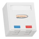
Коммутационные розетки являются составной частью горизонтальных подсистем СКС и предназначены для подключения оконечного оборудования на рабочих местах. Конструктивно розетки могут быть выполнены в двух вариантах: в виде законченного решения с впаянными в печатную плату портами RJ45 и IDC разъемами и в виде пластикового корпуса, в который отдельно устанавливаются коммутационные модули-вставки формата Keystone.
