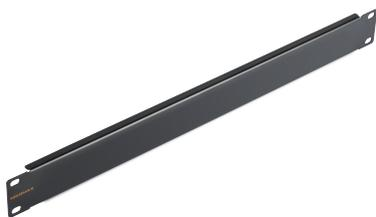
NMC-OK-BLANK-1U-BK, фронтальная заглушка для установки в 19" стойки/шкафы, используется для скрытия неиспользованного пространства между коммуникационным оборудованием, а также для защиты от проникновения пыли.
