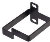
Кольца для вертикальной разводки **NMC-OV600-BK** выполнены из 2 мм стали имеет полезную глубину колец 60 мм и используются для угловых патч-панелей, а так же как дополнение к горизонтальным органайзерам. Данные кольца выполнены в черном цвете и предназначены для упорядочивания вертикальных кабельных потоков в коммутационных шкафах и стойках. Крепёжный комплект поставляется отдельно.
