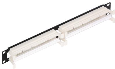
Кроссы 110 типа применяются для разделки на них кабелей различных подсистем СКС. Основным преимуществом 110 кроссов является возможность коммутации каждой отдельно взятой пары, что обеспечивает высокую гибкость переконфигурации кабельной системы. Соединение и коммутация осуществляется при помощи коннекторов 110 типа или соответствующих патч-кордов.
