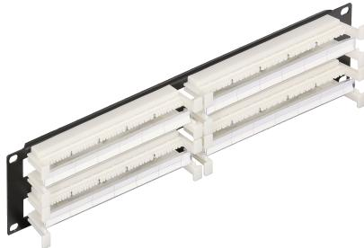
Кроссы 110 типа применяются для разделки на них кабелей различных подсистем СКС. Основным преимуществом 110 кроссов является возможность коммутации каждой отдельно взятой пары, что обеспечивает высокую гибкость переконфигурации кабельной системы. Соединение и коммутация осуществляется при помощи коннекторов 110 типа или соответствующих патч-кордов.
