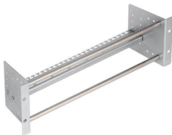
Конструктив **NMC-RCPLWO-3U** с круглыми направляющими предназначен для установки на него до 20 платинтов типа KRONE и может быть установлен в любой шкаф или стойку 19". Круглые направляющие конструктива могут быть установлены в трех различных позициях по глубине. В тыльной части конструктива имеется удобный кабельный органайзер, который также может быть отрегулирован по высоте на одну из пяти возможных позиций. Общая высота конструктива – 3U.
