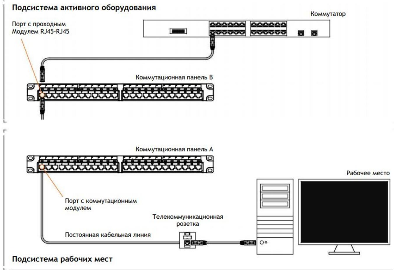
Из-за особенностей конструкции с данными панелями необходимо использовать специально модифицированные модули Keystone с индексом «LS» в артикуле. Основой для модификации послужили компоненты серии NIKOMAX Fast Termination, так что модули «LS» совместимы с инструментом для быстрой заделки NMC-FT-TOOL и доступны всех тех же типов, что и модули «FT». Произвести подключение к активному оборудованию можно при помощи проходных соединительных Keystone-модулей.
