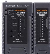
Кабельный тестер NIKOMAX, UTP/STP, RJ11, RJ12, RJ45, с функцией Port Flash и LED фонарем
