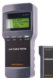
Кабельный тестер с LCD дисплеем, с функцией измерения длины
