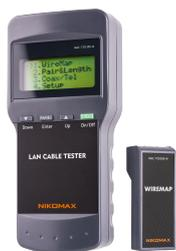
Кабельный тестер **NIKOMAX NMC-TED300** с LCD дисплеем предназначен для работы с кабелями витая пара, оконцованными разъемами RJ45. Тестер способен диагностировать такие ошибки в линии как нарушение схемы разводки проводников, обрыв проводников и короткие замыкания, а так же способен измерить длину кабельной линии. Тестер имеет несколько ячеек хранения параметров калибровки для работы с кабелями разных производителей и категорий.
