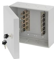
Основное назначение всех распределительных боксов – защита узла коммутации от внешних воздействий и несанкционированного доступа. Кронштейны в боксах предназначены для установки 10-парных плат типа KRONE.
