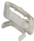
Скрепа NIKOMAX **NMF-AL-EFCT-C** изготовлена из стали марки 304, толщиной 1,5 мм. Толщина материала и размеры скрепы подобраны с таким расчетом, что узел крепления из ленты со скрепой обеспечивает прочное крепление арматуры ВОЛС на опоре, удерживающее ее при неблагоприятных факторах (ветер, гололед), в то же время разрушается при критических нагрузках (падение дерева, падение опорного столба), что обеспечивает целостность кабеля.
