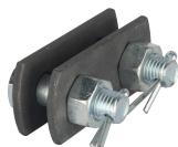
Промежуточное звено NMF-AL-FSE-L-20 предназначено для сцепления арматуры, увеличения и регулировки длины подвески, перехода от одного вида соединения к другому. Состоит из двух стальных плашек соединённых болтами. Разрушающая нагрузка 20 кН.
