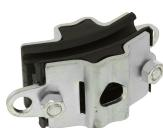
Зажим поддерживающий, для кабеля типа "8", диаметр троса 4 - 9 мм, 8 кН
