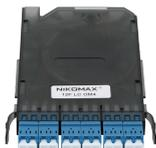
Кассета NIKOMAX волоконно-оптическая, для MTP/MPO кросса, 1 слот, одномодовая 9/125 мкм, стандарта OS2, для организации сварного соединения, до 12 портов LC/UPC, премиум, черная.
