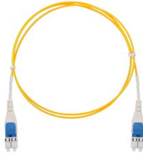
Шнур оптический соединительный, SM 9/125, OS2, Flat Clip LC/UPCx2, нг(A)-HF, где xxx - длина
