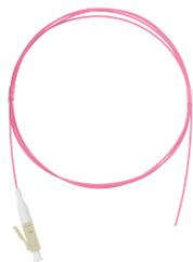
Оптические монтажные шнуры (пиг-тейлы) служат для оконцевания оптоволоконных кабелей разъемами посредством приваривания к ним готового отрезка кабеля заранее оконцованного коннектором в заводских условиях. Такие шнуры изготавливаются из кабелей диаметром 0,9 мм и, соответственно, имеют разъем лишь с одной стороны. Монтажные шнуры могут быть как одномодовыми (желтая оболочка), так и многомодовыми (оранжевая оболочка).
